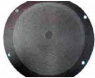
图2 测试后砂纸表面的螺旋线 FIG. 2 Helix of sandpaper surface after test
